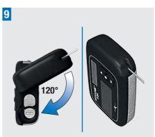
Drehen Sie den Adapter im Uhrzeigersinn bis zum Anschlag. Der Adapter ist korrekt ausgerichtet, wenn er bündig mit dem Pumpengehäuse abschließt.
