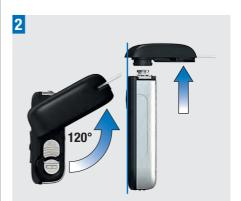
Halten Sie die Pumpe senkrecht. Entfernen Sie den Adapter und die Ampulle und entnehmen Sie die Batterie aus der Insulinpumpe. Siehe Kapitel 2, Seite 18.
