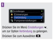
Das Menü Verbindung wird angezeigt.
