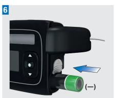
Legen Sie die neue Batterie mit dem Pluspol (+) zuerst in das Batteriefach ein; der Minuspol (–) muss nach außen zeigen.
