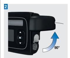
Drehen Sie den Adapter gegen den Uhrzeigersinn in eine 90°-Position.
