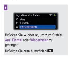
Bei der Einstellung Einmal wird der Signalton nur einmal abgeschaltet. Bei der Einstellung Wiederholen wird der Signalton täglich im festgelegten Zeitraum abgeschaltet.
