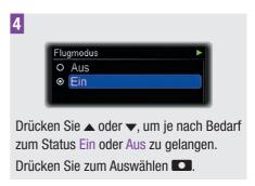
Die Pumpe kehrt zur Standardanzeige zurück. Der Flugmodus wird sofort aktiviert und die drahtlose *Bluetooth*-Technologie wird ausgeschaltet. In der Standardanzeige ist das Flugzeug-Symbol zu sehen.
