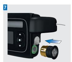
Bringen Sie den Batteriefachdeckel über der Batterie an.
