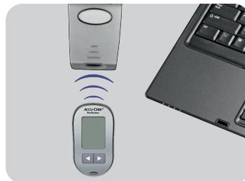
Legen Sie das Messgerät auf einer ebenen Fläche vor die Infrarotschnittstelle (Abstand muss 3 – 10 cm betragen). Folgen Sie den Anweisungen der Software.
