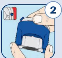
**2** Die Setzhilfe ist nun vorgespannt. Bei diesem Handhabungsschritt wird der Sicherungshebel arretiert und die Setzhilfe automatisch gesichert.
