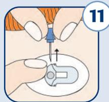
**11** Zum Entfernen der Führungsnadel das Kanülengehäuse am Körper festhalten. Einen Finger auf das Kanülengehäuse legen und die Führungsnadel an ihrem Haltegriff gerade herausziehen.
