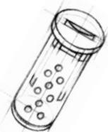
Die Insulinpumpe wird von einem 3-V-Lithium-PowerPack mit Strom versorgt. Dieses PowerPack wurde speziell für Ihre Insulinpumpe entwickelt und spielt bei der Erhaltung ihrer ordnungsgemäßen Funktion eine bedeutende Rolle. Eine in die Abdeckung des PowerPack-Fachs integrierte Membran gleicht den Druckunterschied zwischen Außen- und Innenseite des Insulinpumpengehäuses aus. Der integrierte Dichtungsring bewirkt eine wirkungsvolle Abdichtung des PowerPack-Fachs der Insulinpumpe.
