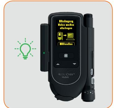
8. **Bei der regulären Blutzuckermessung Bluetooth®** auf dem Smartphone aktiviert lassen. Knopf auf dem Adapter drücken, um den Datentransfer zu starten. Die grüne LED blinkt schnell. Nach dem Datentransfer stellt der Wireless Adapter automatisch ab.
